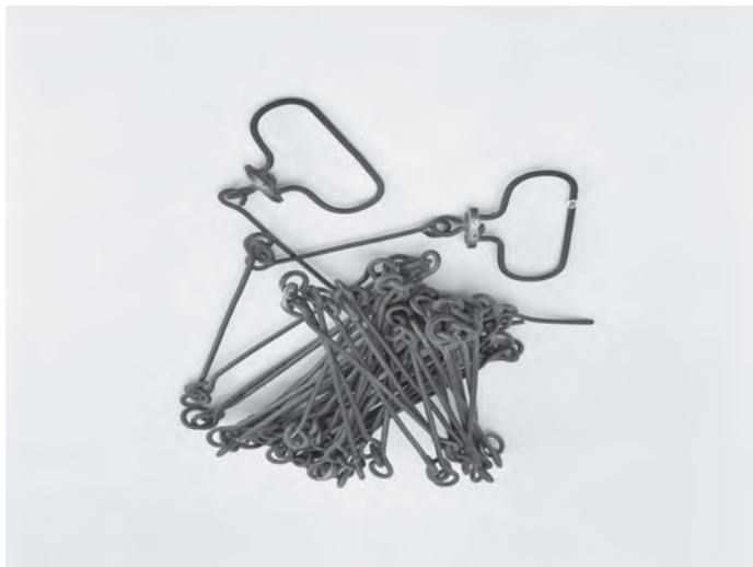
Afb 5: Meetketting van een landmeter
